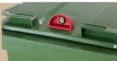
Gravitationslås Gravitationslåset låser upp sig självt när kärlet når en viss vinkel i tömningscykeln. Kärlet låser sig när det ställs tillbaka på marken. Inga nycklar behövs för tömningspersonalen, nyckeln finns hos kunden. Art.nr 844 140
